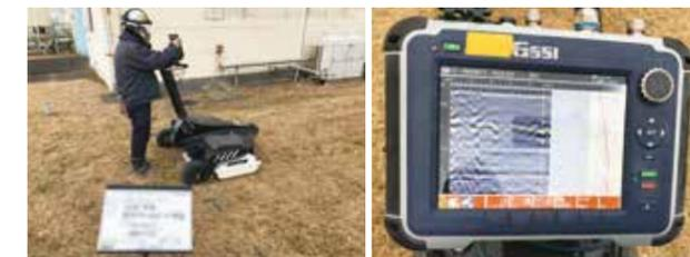
地中レーダー探査「StreamC」使用・探査状況
