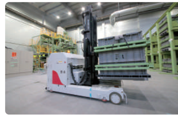
自動搬送装置 (AGV)
