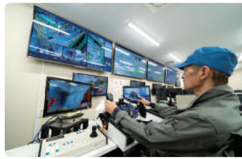
中央操作室からの重機遠隔操作
