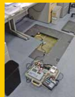
▲ 現地調査状況(振動)
