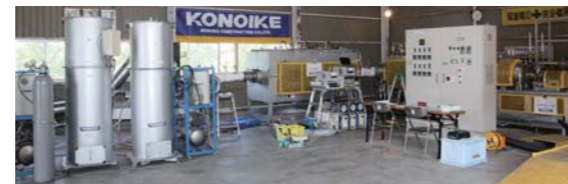
▲バイオマスガス化実証試験装置
