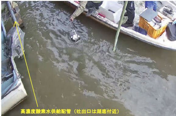
写真 9 吐出部付近での採泥作業状況 (R5. 11. 29)
