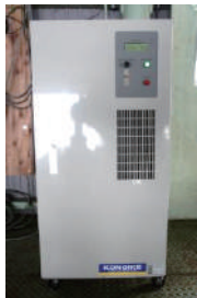
写真3 酸素ガス発生装置
