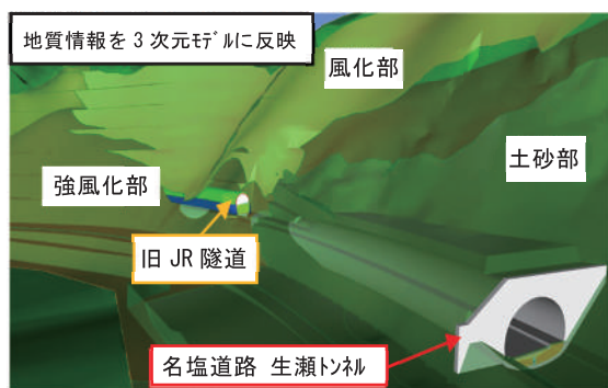
図5 BIM/CIMモデル（地盤情報反映） 1) 一部修正
