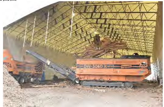
写真1 粗破碎機と破碎機による木くずの二次破碎状況
