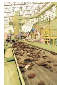
写真5 解体残渣の手選別状況
