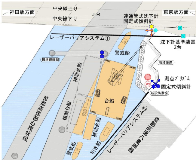
図7 PC ウェル施工時の計測・監視体制
