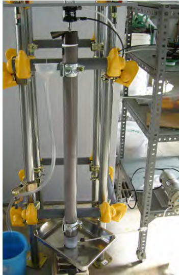
写真4 一次元浸透試験装置（全景）
