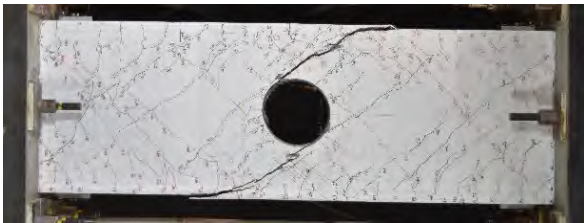
(c) 試験体 No. 3 (H=300、Fc36、pwo=1.68%、po=0.51%)
