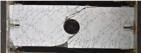
(b) 試験体 No. 2 (H=300、Fc36、pwo=1.68%、po=0.26%)
