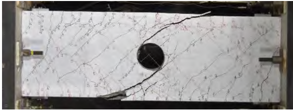
(a) 試験体 No. 1 (H=250、Fc36、pwo=1.68%、po=0.30%)
