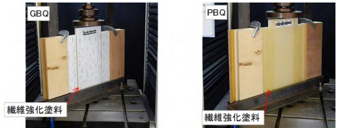
写真 11 試験体設置状況 [せん断試験]
