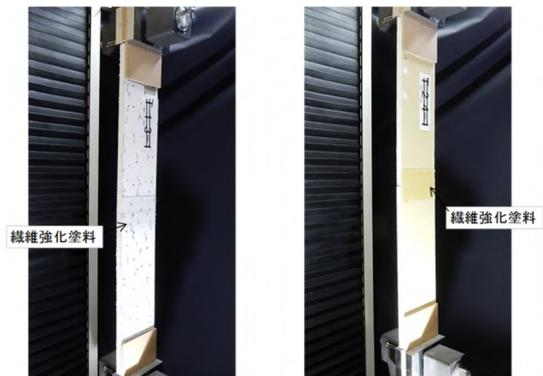
写真9 試験体設置状況 [引張試験] (左：GBT、右：PBT)
