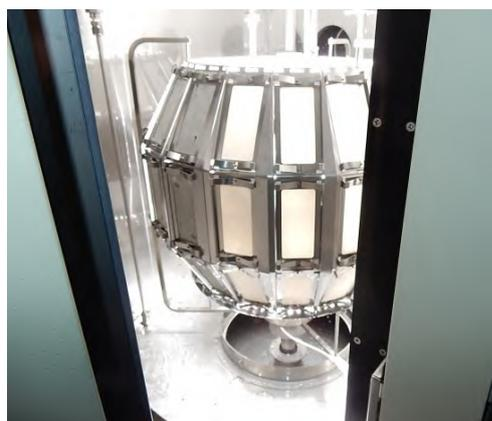
写真3 促進耐候性試験状況
