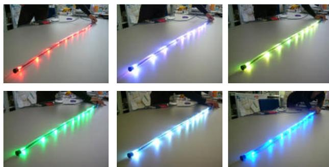
写真1 変位の大きさにより色が変わる「光る変位計」
