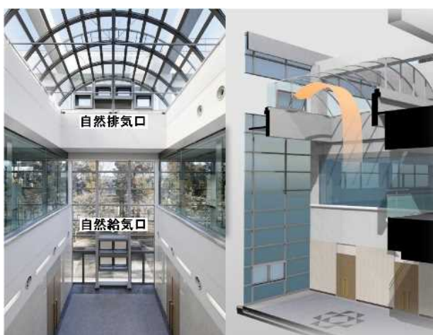
写真1 自然給気口・自然排気口(東面)
