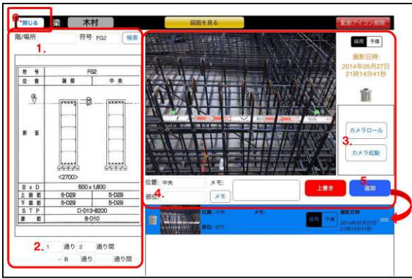
図3 配筋検査入力画面
