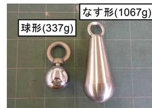
写真4 落錘衝撃試験用おもり
