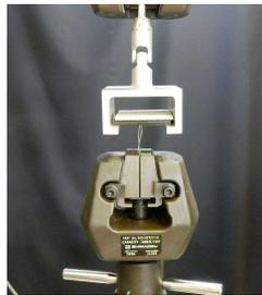
写真9 引張試験状況 (タイルと補助金物)
