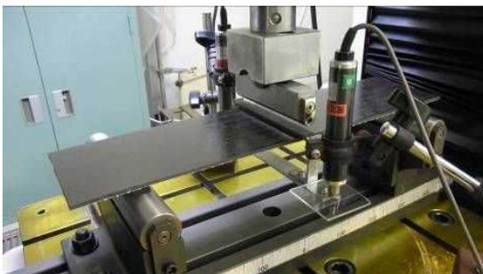
写真3 曲げ試験状況 (タイル面側荷重)
