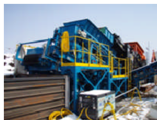
(b) 二次分別 (振動スクリーン) 写真10 分別状況
