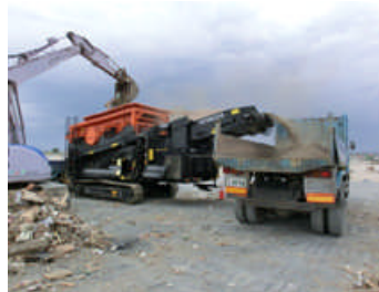
写真 5 分別状況(振動スクリーン)
