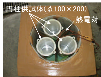
写真4 型枠設置状況
