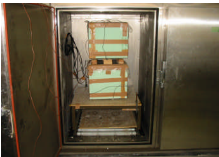
写真1 温度調整装置
