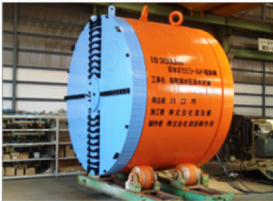
写真5 φ3000mm用泥水式掘進機
