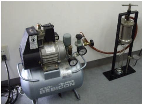
AK-2000 添加による造壁性の向上を確認するための試験装置。鋼製の円筒内に泥水を入れ圧力をかける。初期はフィルターを通過した水がシリンダーに落ちるが、やがてフィルター上に泥膜が形成され通過する水が少なくなる。
