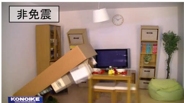
写真3 <免震・非免震>最大応答時(神戸波)
