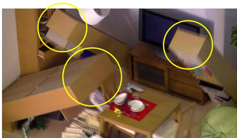
写真5 <非免震>での転倒経過(神戸波)13秒経過時
