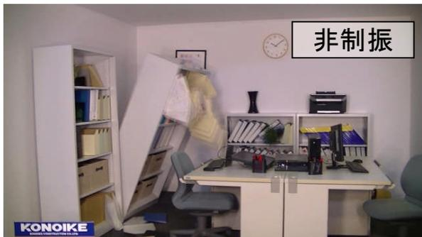
写真4 <制振・非制振>最大応答時(筑波波)
