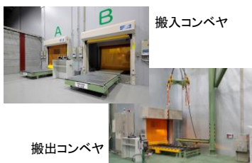
写真2 搬入コンベヤと搬出コンベヤ
