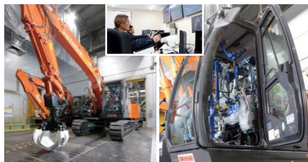
写真5 グラブ仕様重機と遠隔操作機械を設置した操縦席
