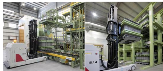
写真6 自動打設装置と自動搬送フォークリフト
