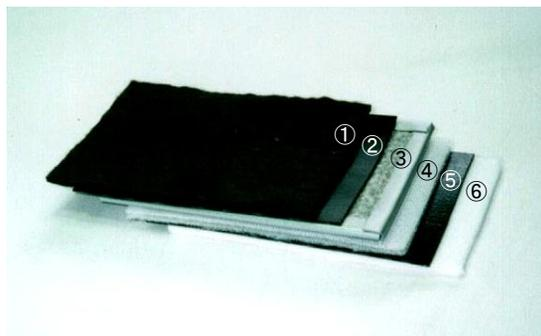
遮水シートは、5つの機能【遮水・排水・保護・漏水位置検知・自己修復】を持ち、写真に示すように6層で構成されます。各層が効果的に役割を果たすことで多重バリアを形成します。
