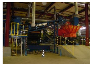
⑤破砕 手選別された廃棄物を70mm以下に破砕
