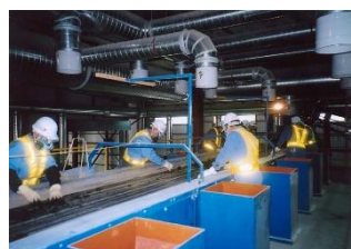
④手選別 塩ビ・廃プラ類、破砕不適合物を除去
