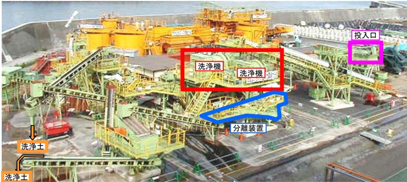
土壌洗浄設備全景（処理能力30m<sup>3</sup>/Hr + 10m<sup>3</sup>/Hr）
