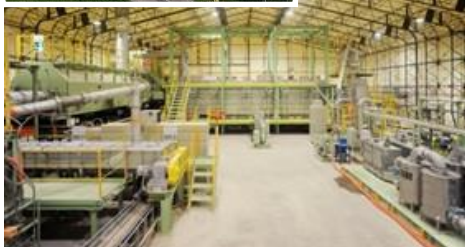
ジオスチーム工法 (対象:低沸点重金属、油、ダイオキシン類、PCB、農薬)
