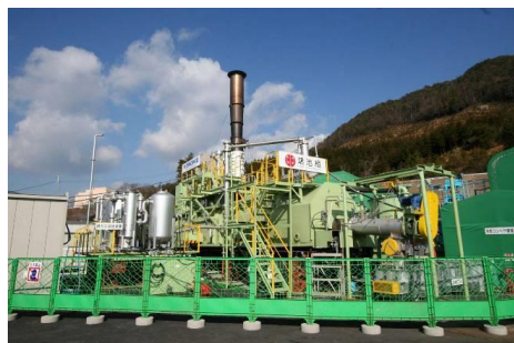
TPS+ジオメルト工法 (対象:全汚染物質、特にダイオキシン類、PCB、農薬)
