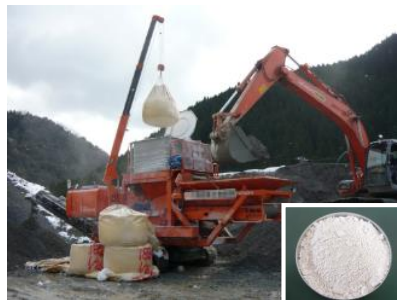
固化・不溶化工法(対象:重金属等)
