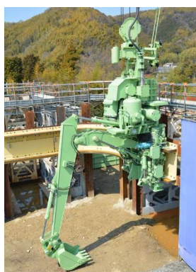
異形断面に対応した水中掘削機
