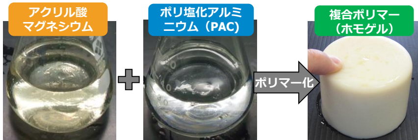
写真-1 二液混合による注入材のゲル化
