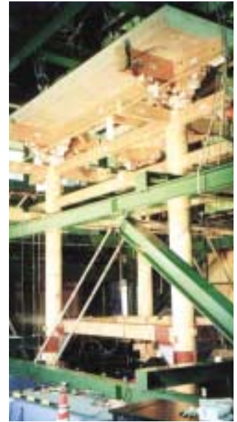
構造実験で伝統木造建造物の構造特性を把握
