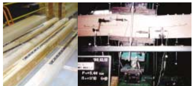
継ぎ手のステンレス補強 (右: 当社技術研究所での性能確認試験)
