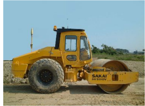
GPSと加速度計を搭載した振動ローラ
