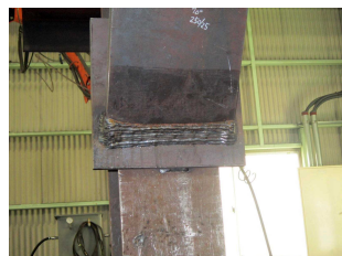
写真6 現し塗装部 溶接試験片
