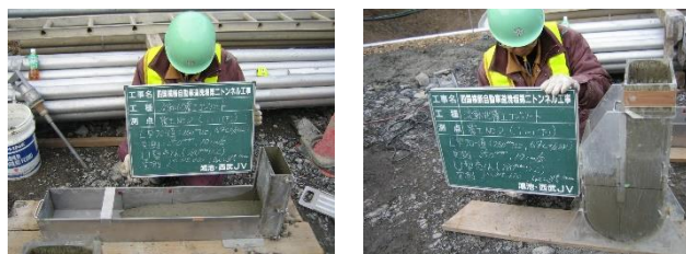
写真-3 高品質・高充填覆工コンクリート品質管理試験
