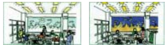
【外が明るいと抑えて点灯】 【外が暗くなると明るく点灯】 図 8 日光による照度制御
